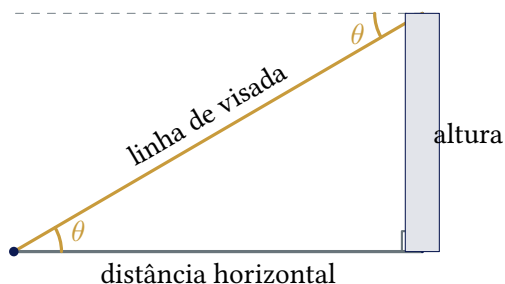
Figura 28.10: Ângulos de elevação e depressão determinados por horizontais paralelas.
